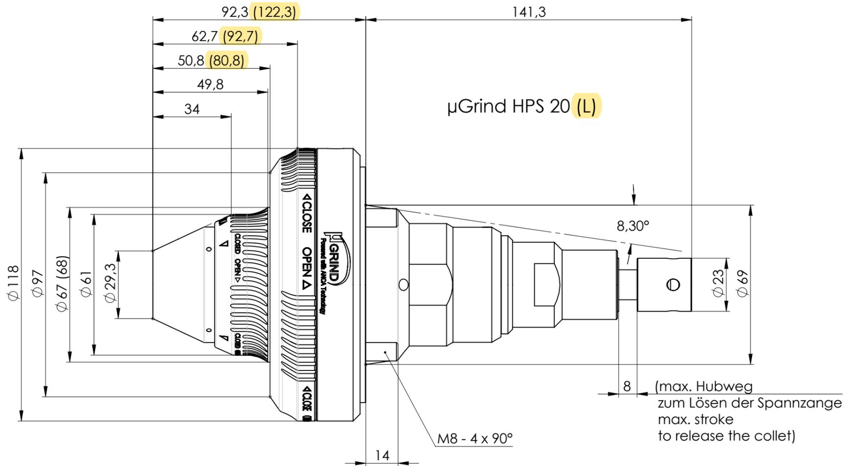
Minimale Lösekraft (maschinenseitig): 4.000 N
